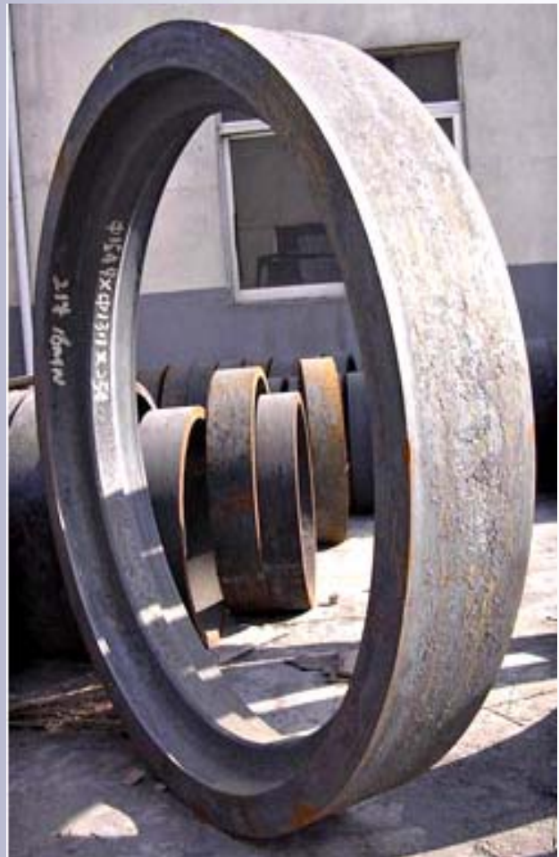
Sección T Forjada de 57 pulgadas
